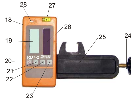
Рис. 3 Детектор лазерных лучей RD7-2
